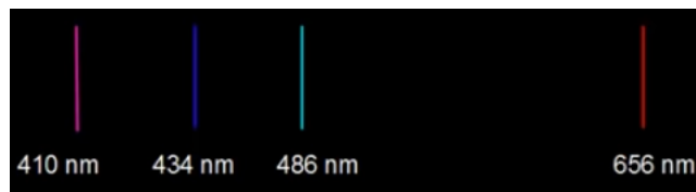
Σχήμα 2.4: Το ορατό φάσμα του υδρογόνου. Οι τιμές υποδηλώνουν το αντίστοιχο μήκος κύματος.
