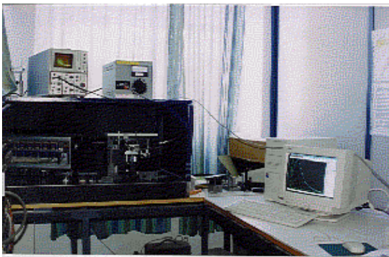
Εικόνα 3. Πειραματική διάταξη για τη φασματοσκοπία του laser επαγόμενου φθορισμού με φασματογράφο και συστοιχία φωτοδιόδων
