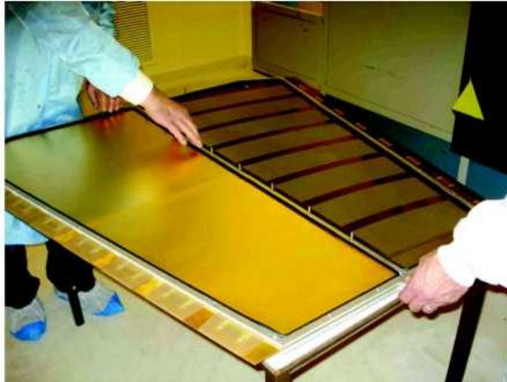
Σχήμα 1.15: Η συναρμολόγηση ενός μεγάλου ανιχνευτή Micromegas [2].
