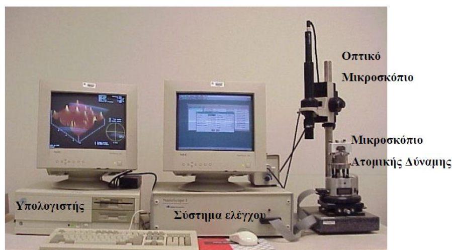
0-2: Σύστημα απεικόνισης AFM. Αποτελείται από το AFM, το ηλεκτρονικό σύστημα έλεγχου και το υπολογιστή που διαθέτει λογισμικό απεικόνισης της ακίδας. [17]
