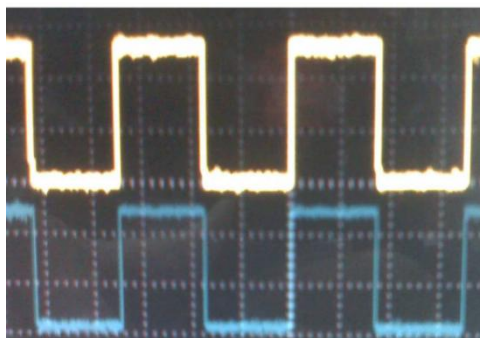
Σχήμα 4.3: Το τεμαχισμένο σήμα όπως απεικονίζεται στον παλμογράφο
