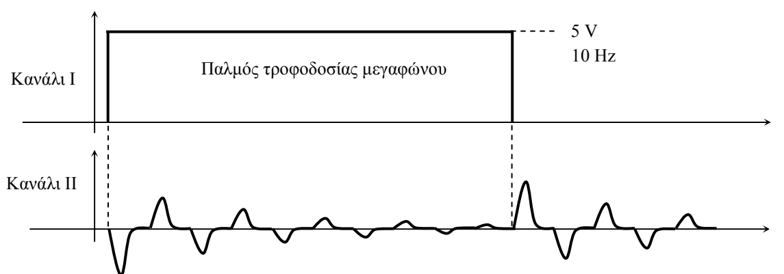
Σχήμα 28.7 Οι παλμοί του μικροφώνου από διαδοχικές ανακλάσεις του ήχου, όταν το ελεύθερο άκρο του σωλήνα είναι ανοικτό, όπως αυτοί φαίνονται στην οθόνη του παλμογράφου (Βλ. Παράγρ Π28.6).
