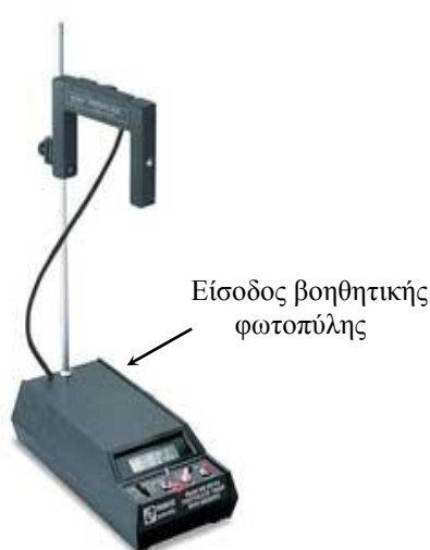
Σχήμα 7.3 Η κύρια φωτοπύλη με το χρονόμετρο.
