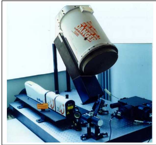
Εικόνα 2. Το σύστημα lidar του ΕΜΠ για την μέτρηση των αερολυμάτων στην ατμόσφαιρα.
