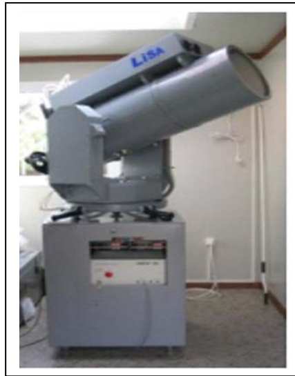
Εικόνα 4. Το σύστημα lidar του INOE (Ρουμανία) για την μέτρηση των αερολυμάτων στην ατμόσφαιρα.
