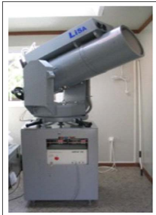
Εικόνα 1.1: Το σύστημα lidar του INOE (Ρουμανία) για τη μέτρηση των αερολυμάτων στην ατμόσφαιρα.
