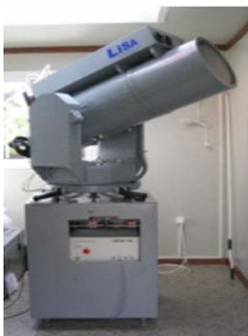
Εικόνα 3. Το σύστημα lidar του INOE (Ρουμανία) για την μέτρηση των αερολυμάτων στην ατμόσφαιρα.
